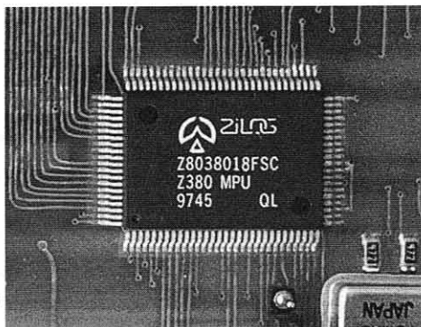
Microprocesador Zilog Z380
